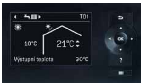
Displej regulace tepelného čerpadla Vitotronic 200.
