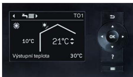
Regulace tepelného čerpadla Vitotronic 200.
