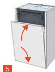
5 Čelní kryt nastavte na dno vzduchové komory – natočte směrem nahoru – uzamkněte – hotovo.
