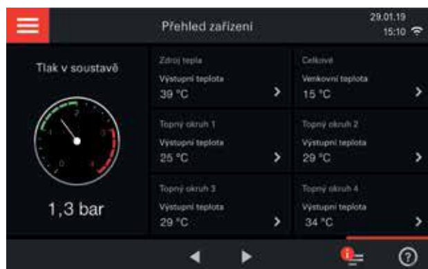
Digitální indikace tlaku pro všechna zařízení Vitodens.
