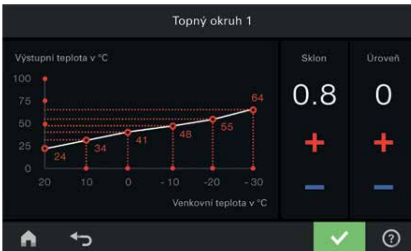
Topné charakteristiky nových plynových kondenzačních kotlů lze optimalizovat online pomocí Vitoguide.
